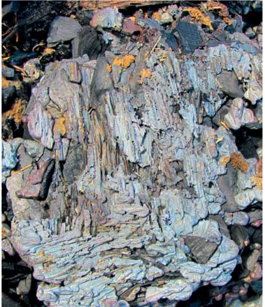
Abb. 6: Rennofenschlacke mit Abdrücken der Strohfällung der Schlacken-grube | Foto: M. Brumlich Iron smelting slag with impressions of the straw filling of the slag pit.
