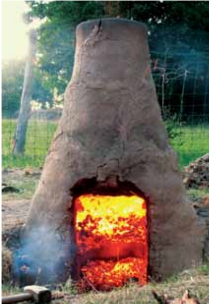
Abb. 2: Der nach dem Verhüttungsprozess aufgebrochene Rennofen. In der Schlackengrube sitzt unterhalb der rechts und links erkennbaren Düsen die Eisenluppe. Darunter befindet sich der Schlackenklotz, von dem bereits Teile entfernt sind. Foto: N. Wachholz The open furnace after the completed smelting process. The bloom in the slag pit below the tuyères visible on both sides. The slag block is situated underneath; some parts have already been removed.
