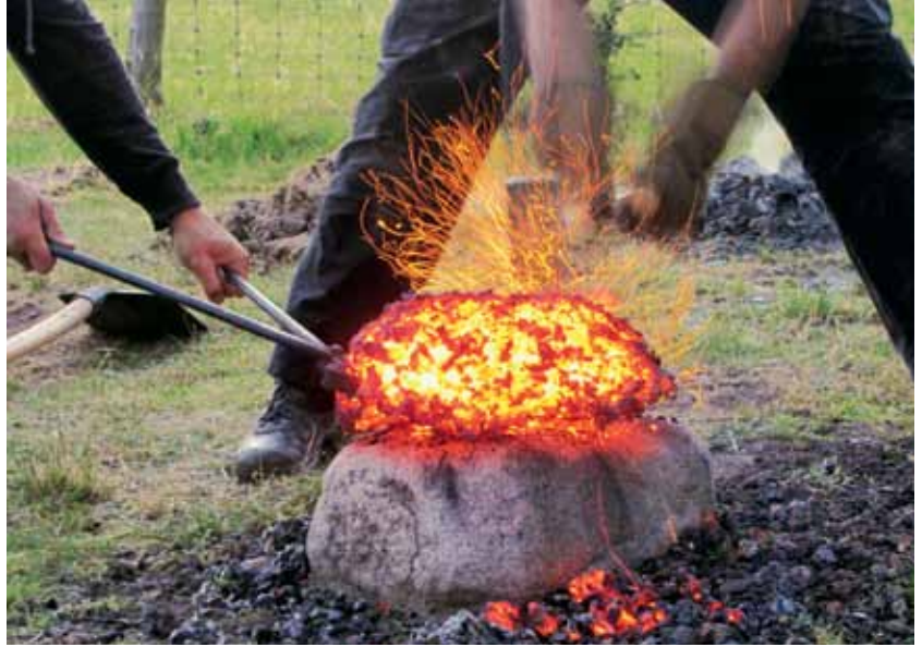
Abb. 3: Bearbeitung der fast 11 kg schweren Eisenluppe auf einem Ambossstein neben dem Rennofen.
