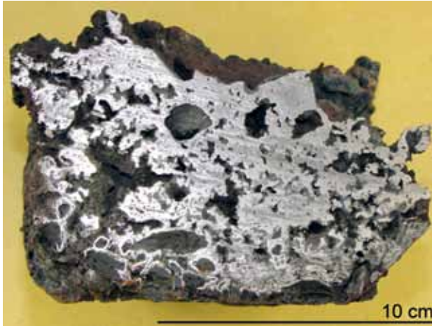
Abb. 4: Querschnitt durch die Eisenluppe mit typisch schwammartiger Struktur. Im unteren Teil Einschlüsse von Holzkohlen.
