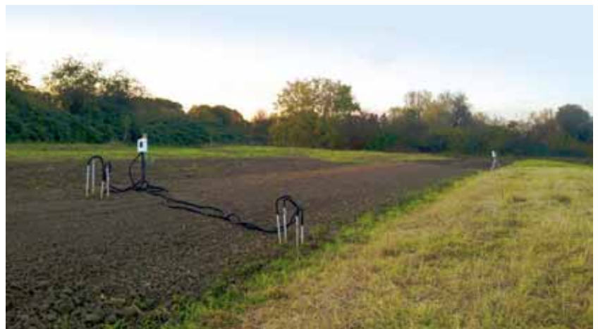
Abb. 5: Sensoreinheit zur Messung der Bodenfeuchte und Bodentemperatur auf den Wölbackern. Gemessen wird in den Tiefen 10 cm und 30 cm Foto: © Verwaltung der Staatlichen Schlösser und Gärten Hessen (VSG) Sensor unit for the measurement of soil temperature and soil humidity on the ridge and furrows. The measurements are taken at the soil depths of 10 and 30 cm
