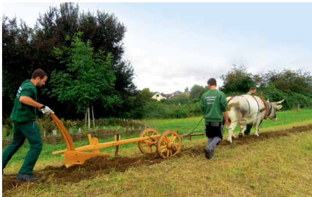
Abb. 4: Ermittlung der Zugleistung eines Ochsen der Rasse Rätisches Grauvieh beim Ziehen eines (re)konstruierten Beetpfluges auf einem der Wölbackerbeete im Freilichtlabor. Foto: © Verwaltung der Staatlichen Schlösser und Gärten Hessen (VSG) Determining the draft power of an oxen of the breed Raetian Grey while pulling a (re)constructed medieval wheel plough on one of the ridge and furrows in the Open Air Laboratory
