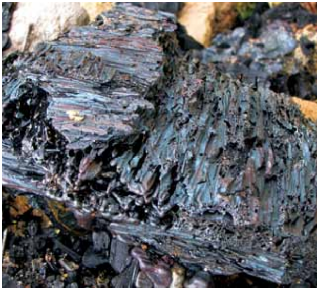
Abb. 8: Verhüttungsschlacke mit Abdrücken von der Strohfüllung der Schlackengrube. Foto: M. Brumlich. Iron smelting slag with impressions of the straw filling of the slag pit.
