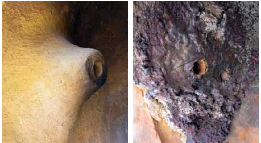
Abb. 3: Die linke Düse des VersuchsrennOfens vor dem Verhüttungsprozess. Foto: M. Brumlich. The left tuyere of the bloomery furnace before the iron smelting process.
