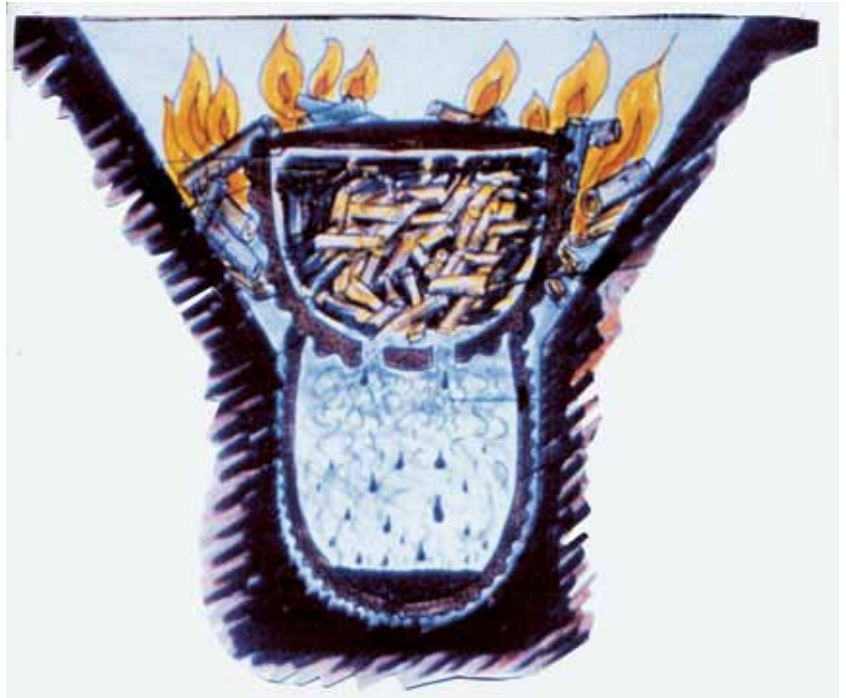
Abb. 3: Prinzip des Doppelpotverfahrens in der Grube. Zeichnung/Drawing: A. Kurzweil Principle of the doublepot-method.
