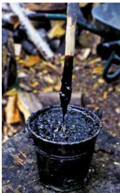
Abb. 8: Ergebnis: Wässriger Teer mit Verunreinigungen. Foto: D. Todtenhaupt Result: watery tar with contaminations.
