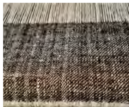
Abb. 32: Detail des Gewebes in Köper 2/1 auf dem Trittwebstuhl. | Foto: Eva-Maria Pfarr Detail of weaving in 2/1 twill.
