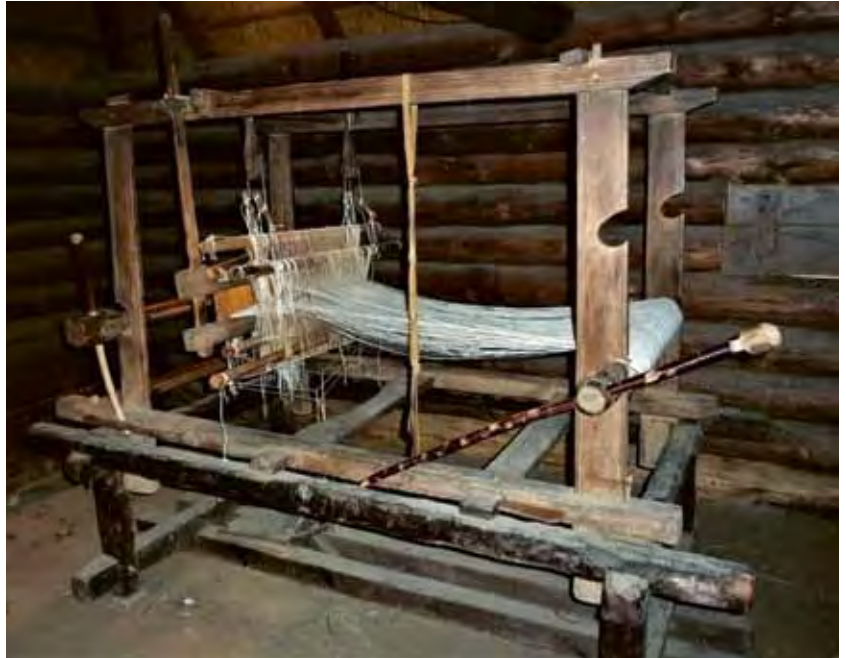
Abb. 30: Der Trittwebstuhl mit den aufgebäumten Kettfäden, die bereits durch Litzen und Kamm gezogen sind. | Foto: Kerstin Behrend The shaft loom with the new warp just after having put the threads through heddles and reed.
