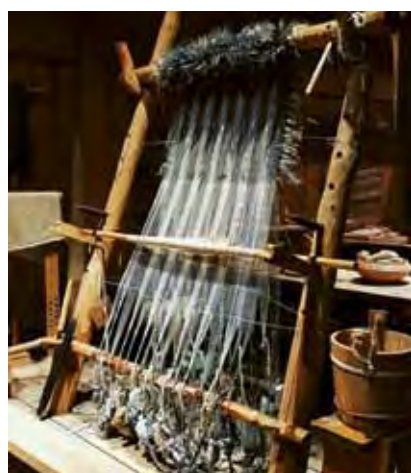
Abb. 25a, b: Wolltuch mit eingewebten Wollflocken als Abbildung (a) und während der Herstellung (b). Foto: https://robbielafleur.com/2013/08/20/traditional-icelandic-rya-knots-a-contemporary-adaption/ Wool cloth with added strands of raw wool for rain protection as a drawing (a) and during the weaving process (b).
