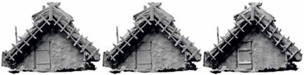
Abb. 7: Vergleich zwischen dem hochauflösenden 3D-Modell (links), dem reduzierten 3D-Modell (Mitte) und dem reduzierten 3D-Modell mit den Details in der Bildtextur (rechts).
