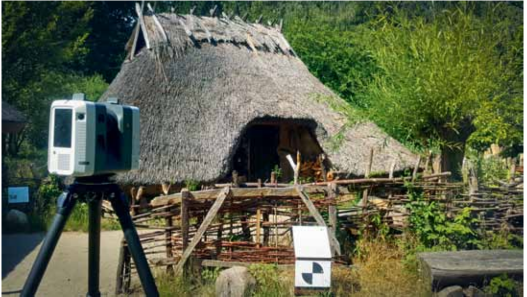
Abb. 3: Der Leica RTC360 3D-Laserscanner bei der Digitalisierung des Museumsdorfs. Foto: Arie Kai-Browne The Leica RTC360 laser scanner used for digitizing the museum village.
