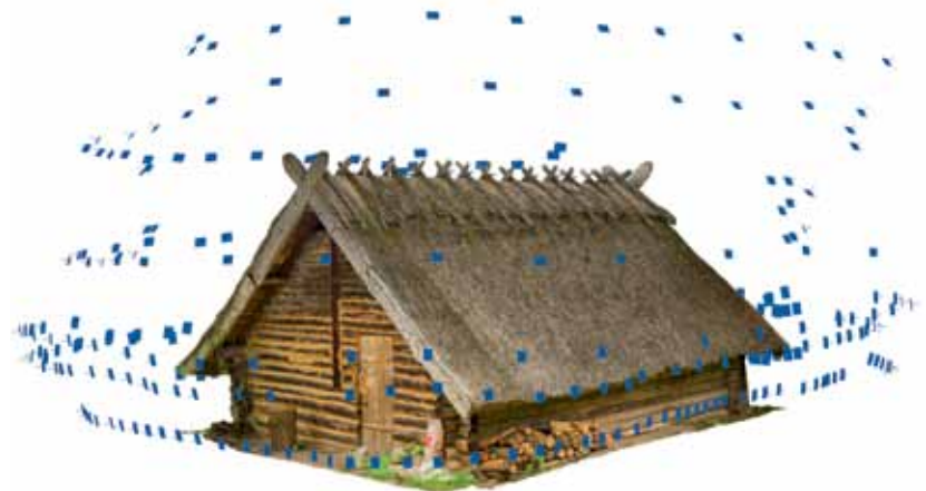
Abb. 1: Ergebnis der bildbasierten 3D-Modellierung. Die blauen Rechtecke repräsentieren die berechneten Kamerapositionen.
