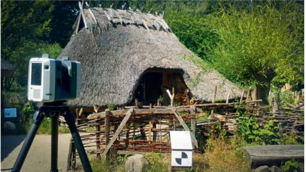
Abb. 3: Der Leica RTC360 3D-Laserscanner bei der Digitalisierung des Museumsdorfs.
