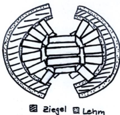
Abb. 8: Kegelstumpfofen, Draufsicht.
