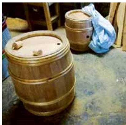
Abb. 11: Zwei mit Fichtenteer verpichte neue Eichenfässer mit Weidenringen. Foto: Eva Götting © Förderverein Museumsdorf Düppel Two new pitched oak barrels with willow rings.
